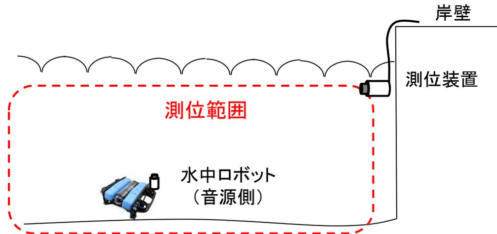
市販の音響測位装置でも水平方向測位は可能であるが
